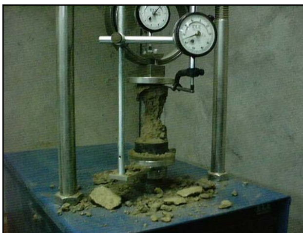
FIGURA 4. Configuración del ensayo UCS y forma de falla típica.
