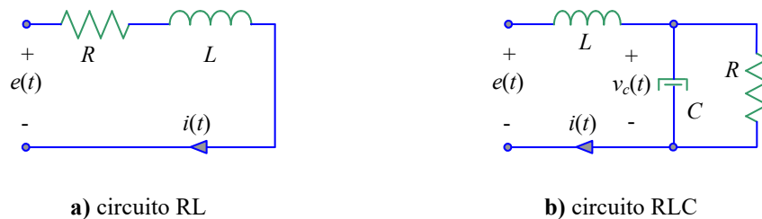
Fig. 1.6 Clasificación de modelos; a) lineales y no-lineales, b) dinámicos y estáticos.
